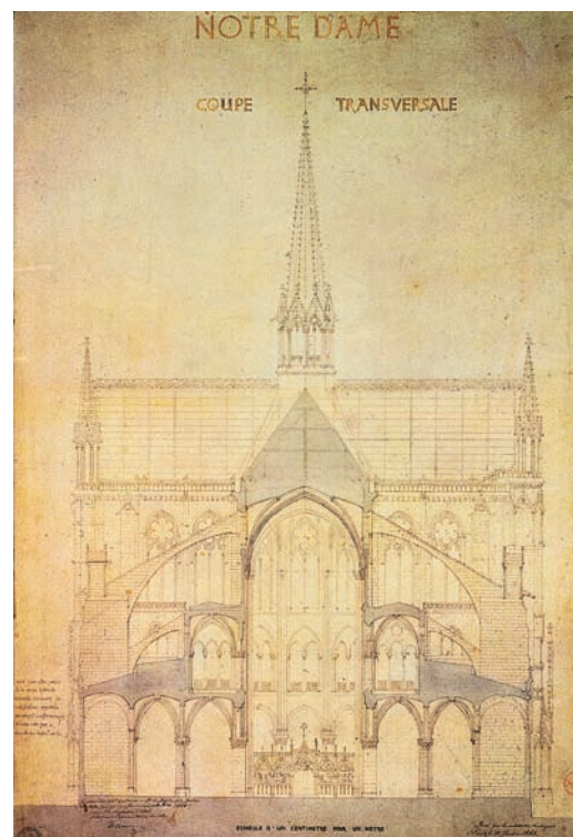
Coupe transversale sur la nef. Dessin de Lassus et Viollet-le-Duc, 1843
